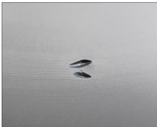
图15 焊接气孔
