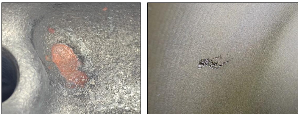
图5 腐蚀
